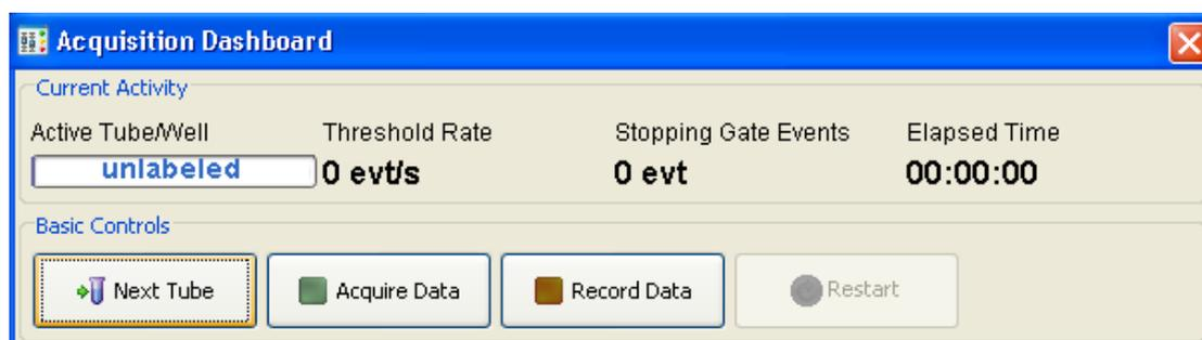
3. 讓儀器在 High Flow Rate 模式下，Acquire 5 分鐘。5 分鐘後，再按一次 Acquire 以中止收取。
